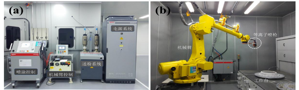
图 2.4 Oerlikon Metco UniCoatPro 大气等离子喷涂设备: (a)控制部分; (b)喷涂部分
